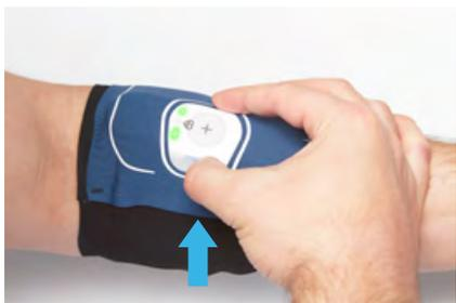
En fonctionnement **Manuel**, l'enregistrement peut être arrêté en appuyant plus de 5 secondes sur le bouton ON/OFF. Le dispositif va émettre deux courtes vibrations et une troisième plus longue. L'état de
