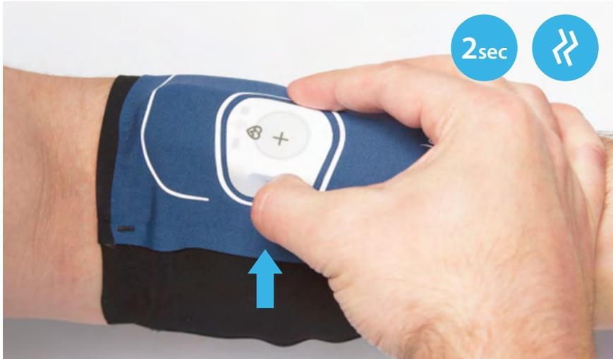
Pour allumer le dispositif, maintenir le bouton ON/OFF enfoncé pendant 2 secondes. Il va émettre deux courtes vibrations et automatiquement afficher l'état de fonctionnement du dispositif pendant 10 secondes.
