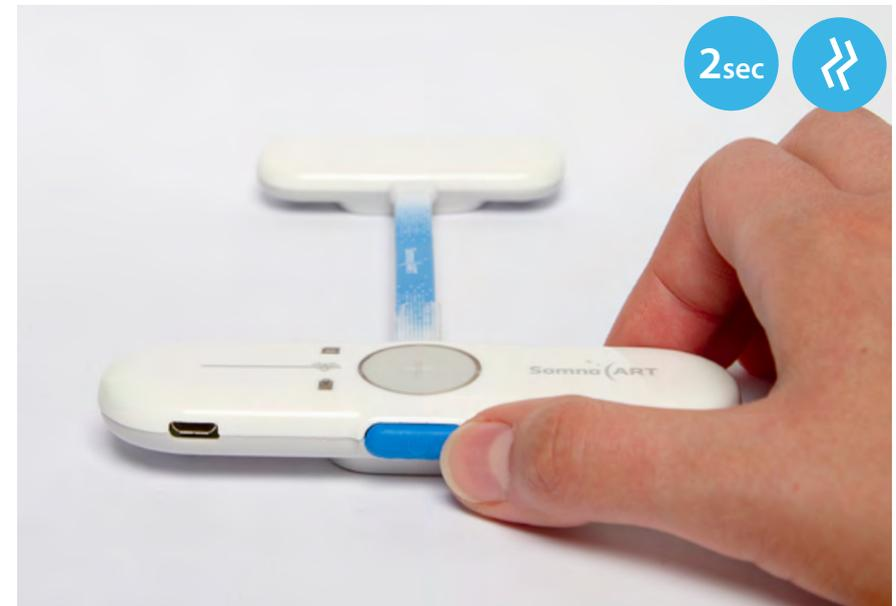
Pour allumer le dispositif, maintenir le bouton ON/OFF enfoncé pendant 2 secondes.
