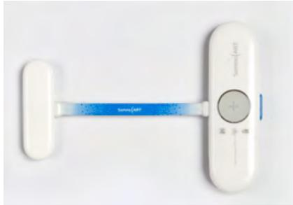
Il permet d'enregistrer le rythme cardiaque en battements par minute (BPM) à une fréquence de 1 Hz. Les mouvements sont enregistrés sur les trois axes et cumulés à la seconde.
