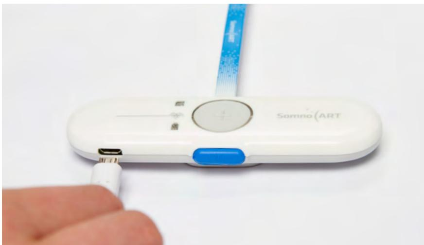
Le boîtier d'enregistrement se recharge en le connectant au port USB d'un ordinateur.
