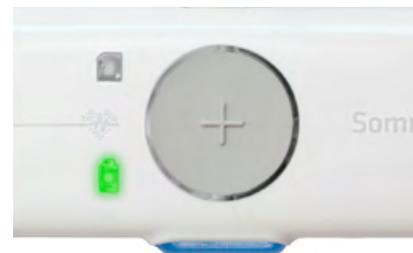
Lorsque le boîtier d'enregistrement est en charge, la LED batterie clignote en vert. Une fois le boîtier chargé, la LED cesse de clignoter et reste verte.
