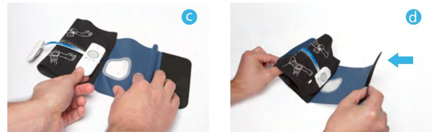
Faire glisser les extrémités du boîtier d'enregistrement dans les encoches de fixation. Une fois le dispositif en place, refermer le brassard à l'aide des fermetures éclair et fixer avec la bande Velcro centrale.
