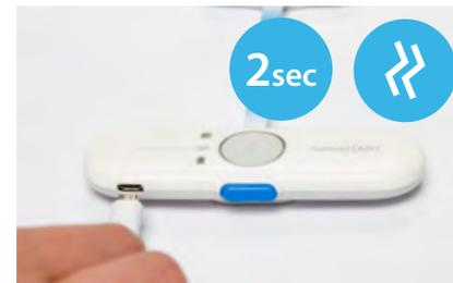
Brancher le câble USB au dispositif puis à l'ordinateur. Le dispositif va émettre deux courtes vibrations et automatiquement afficher l'état de fonctionnement du dispositif.
